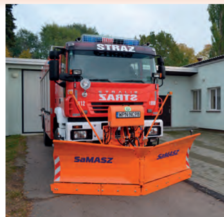
Fot. UG Gmina Raciąż dysponuje własnym sprzętem do odśnieżania dróg gminnych. Na zdjęciu pług do odśnieżania zamontowany przy wozie strażackim OSP Dobrska Kolonia.
